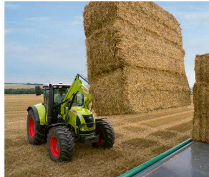
El cargador frontal está totalmente integrado y equipado con brazos elevadores plegables. Con la poca distancia entre el punto de acoplamiento y el eje delantero, usted saca ventaja en todos los trabajos de un preciso seguimiento del suelo. En combinación con la toma de fuerza delantera, el cargador frontal le permite una gama de usos extraordinariamente versátil.
